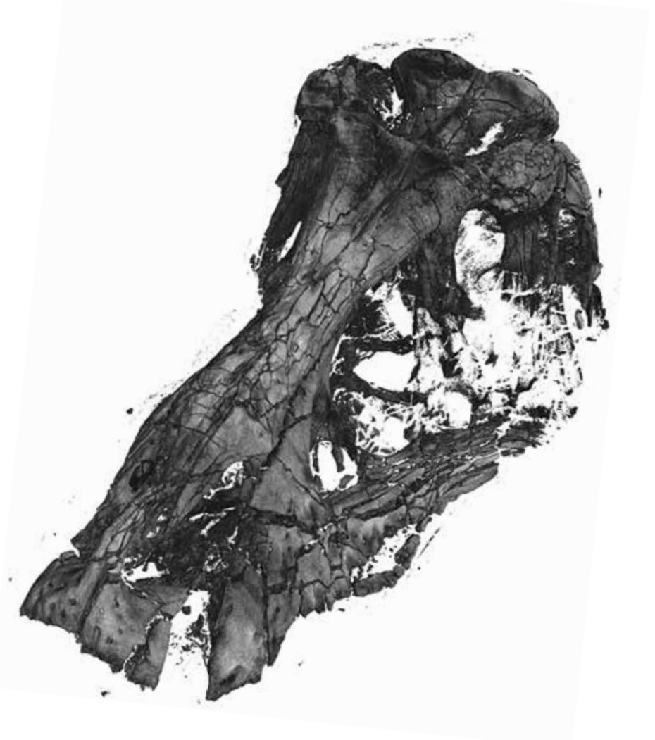
Aus einer Blockbergung segmentierter T-Rex Schädel, d. h. unter Ausblendung der Sand/Gesteins-Matrix sowie den Befestigungen der Holzkiste (Foto: Naturalis Biodiversity Center/ Fraunhofer IIS)
