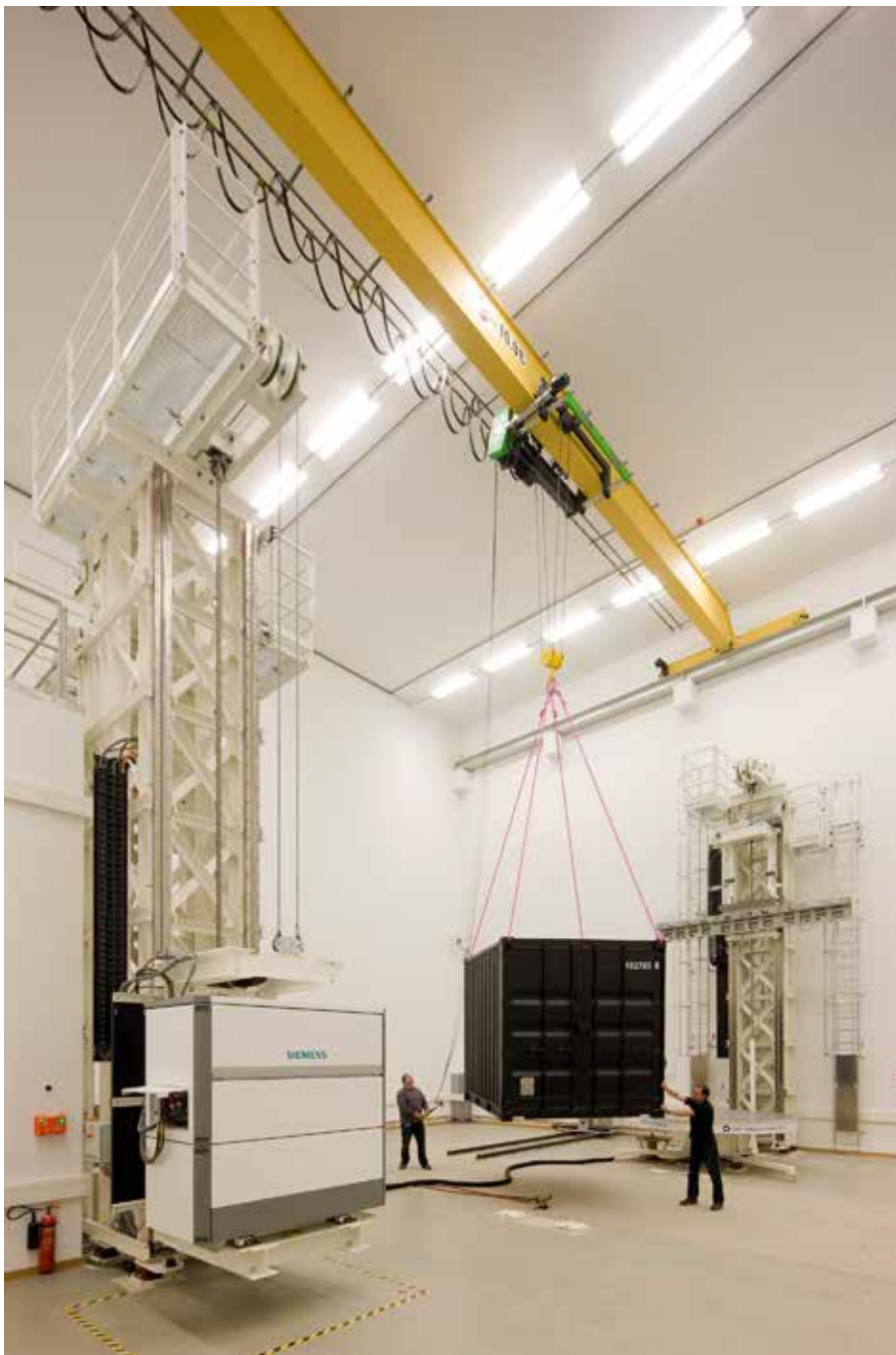
Positionierung eines beladenen Containers auf dem Drehteller für ein hochauflösendes 3D-CT in der LINAC-Testhalle per Deckenkran (Foto: Fraunhofer IIS, Kurt Fuchs)
