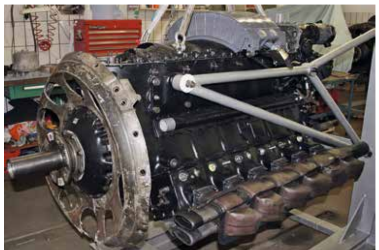
Original JuMo 211: 12 Zylinder-Reihenmotor, obenliegende Kurbelwelle, 720 kg Masse, 35 l Hubraum, von Junkers Motoren (Foto: Peter Pietschmann)
