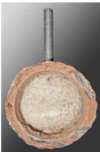
Querschnitt durch eine Tonröhre mit gefülltem „Ankerstrumpf“ zur Veranschaulichung des Dübel-systems (Foto: Thomas Salveter)
