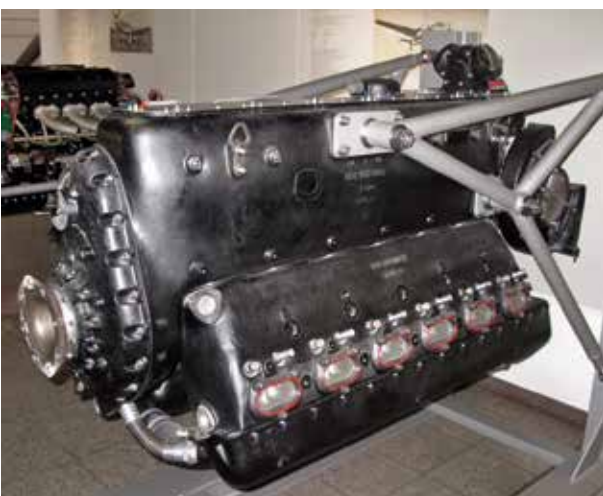
Original DB 601: 12 Zylinder-Reihenmotor, obenliegende Kurbelwelle, 610 kg Masse, 34 l Hubraum, von Daimler Benz (Foto: BLfD, Matthias Blana)
