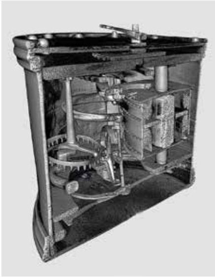
Die 3D-CT erlaubt den Blick in das Innerste der „Henlein“-Taschenuhr (Foto: Germanisches Nationalmuseum Nürnberg)
