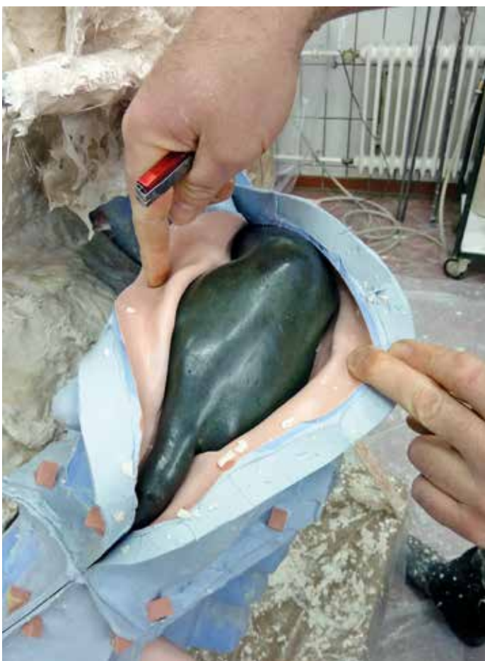
Nach Entfernen der Gipsschale wird die Silikonform an den Trennstegen aufgeschnitten, in Einzelteilen abgenommen und in die entsprechenden Formteile aus Gips eingelegt
