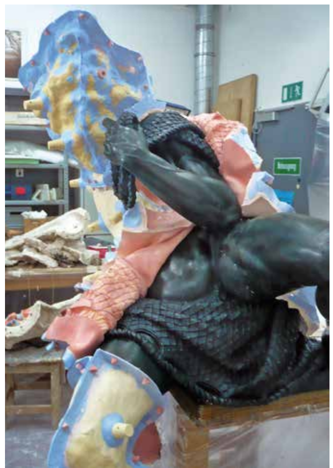
Nach Entfernen der Gipsschale wird die Silikonform an den Trennstegen aufgeschnitten, in Einzelteilen abgenommen und in die entsprechenden Formteile aus Gips eingelegt
