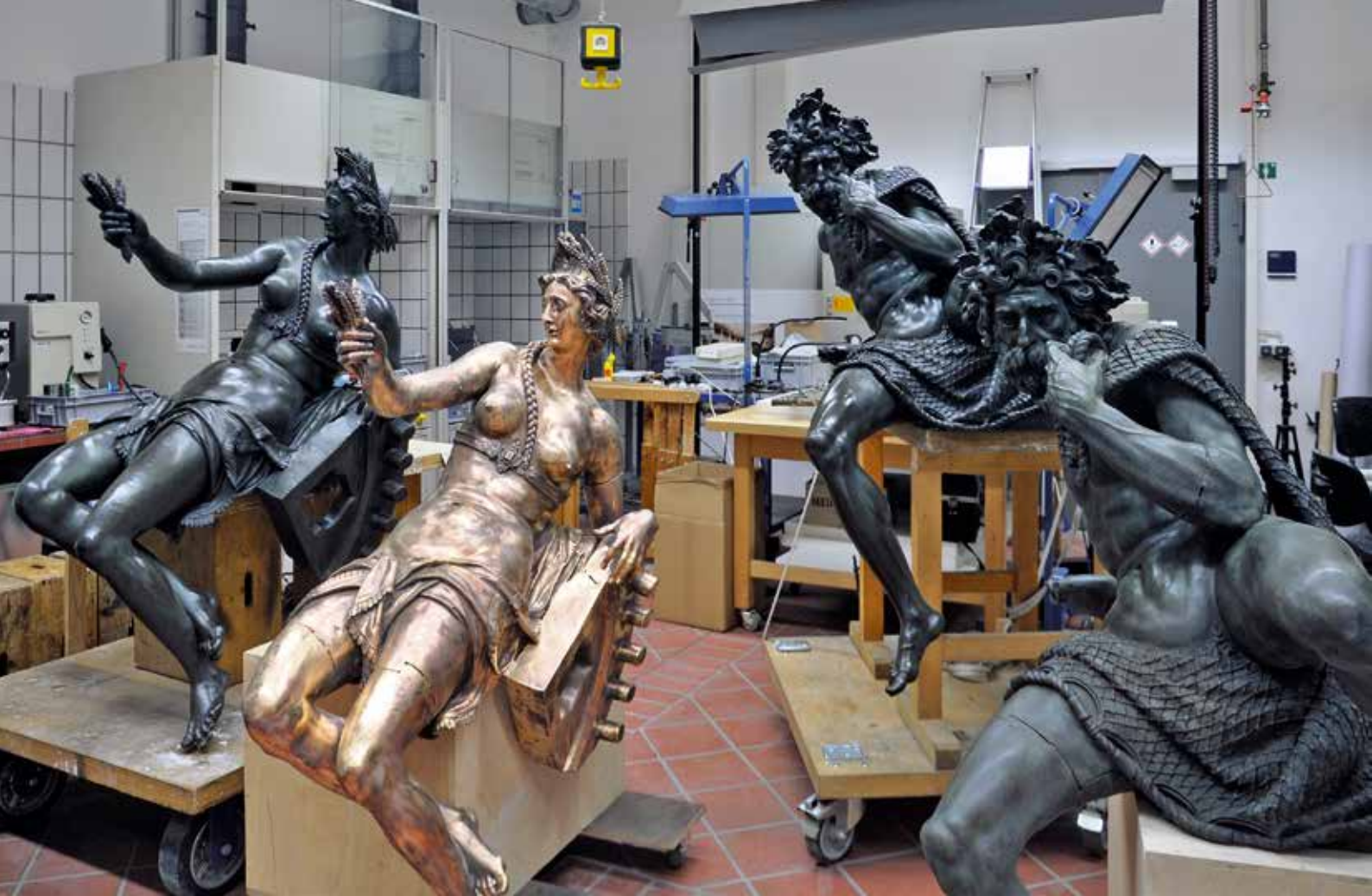
Zwei Originale, zwei Abgüsse. Der Flussgott im Vordergrund ist entsprechend dem Original patiniert. Die Fügenähte der gegossenen Einzelteile sind nur geheftet und werden nach dem Vergleich vollständig geschweißt
