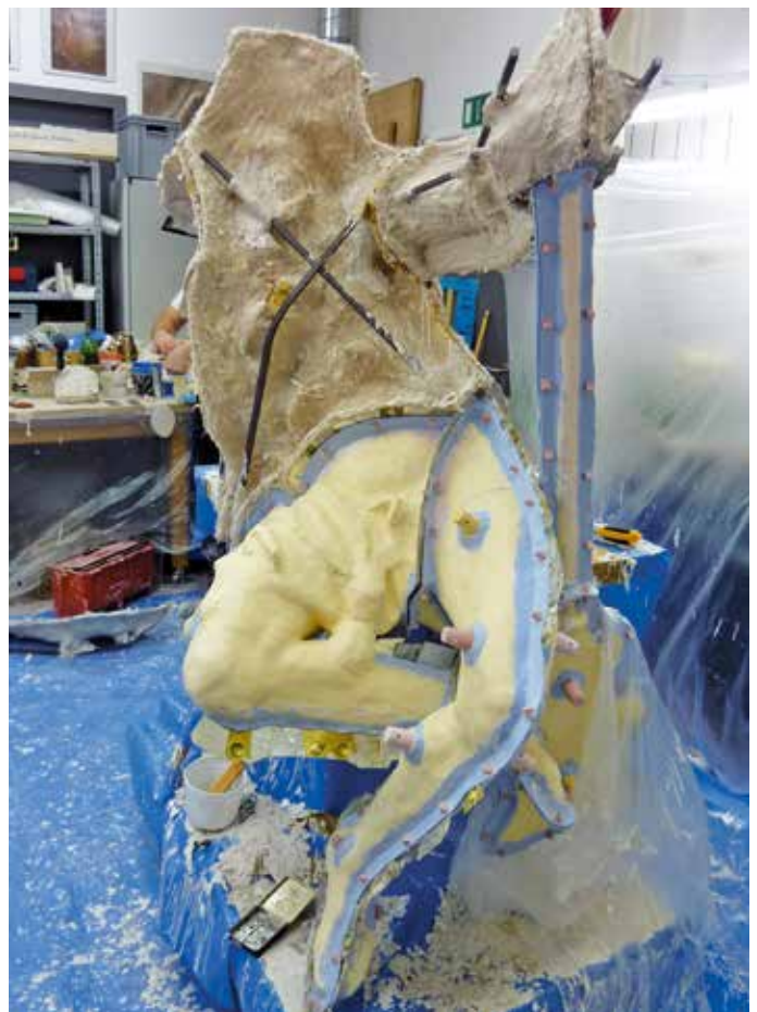
Die Gipsschale erhält Haltegriffe, die dem Wachser in der Gießerei das Ausschwenken der Formteile mit flüssigem Wachs ermöglichen
