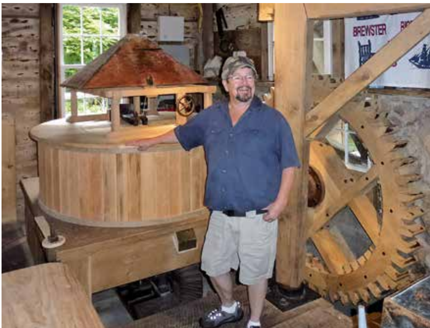
Brewster Gristmill mit neuem Mahlwerk (der Kornkasten oben ist umgedreht), rechts der stationäre Kran zum Heben der Mühlsteine. Im Bild der ehem. Müller S. Goodwin (Foto: C. Sebastian Sommer, 2013)
