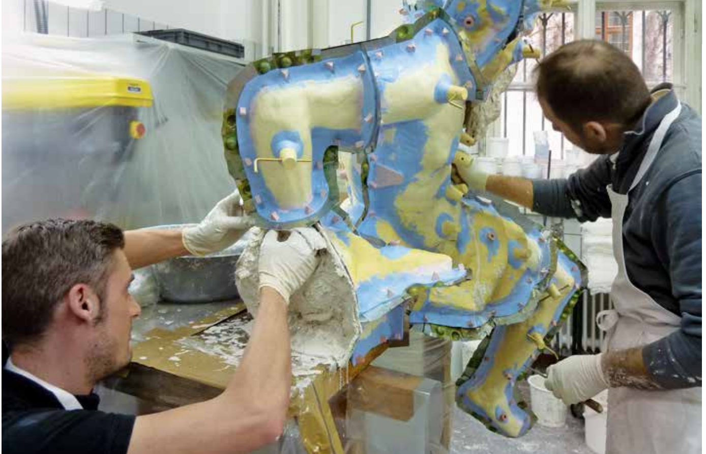
Die Formenbauer beim Aufbringen der Gipsschale. Die zuvor eingearbeiteten Metallplättchen ermöglichen die Trennung in Einzelteile
