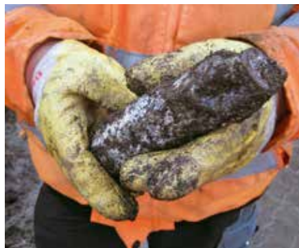
Eine von mindestens fünf InC 4lb-Stabbrandbomben (mit Elektron-Thermit-Stab) (Foto: ArchDienst GmbH & Co. KG, Matthias Tschuch)
