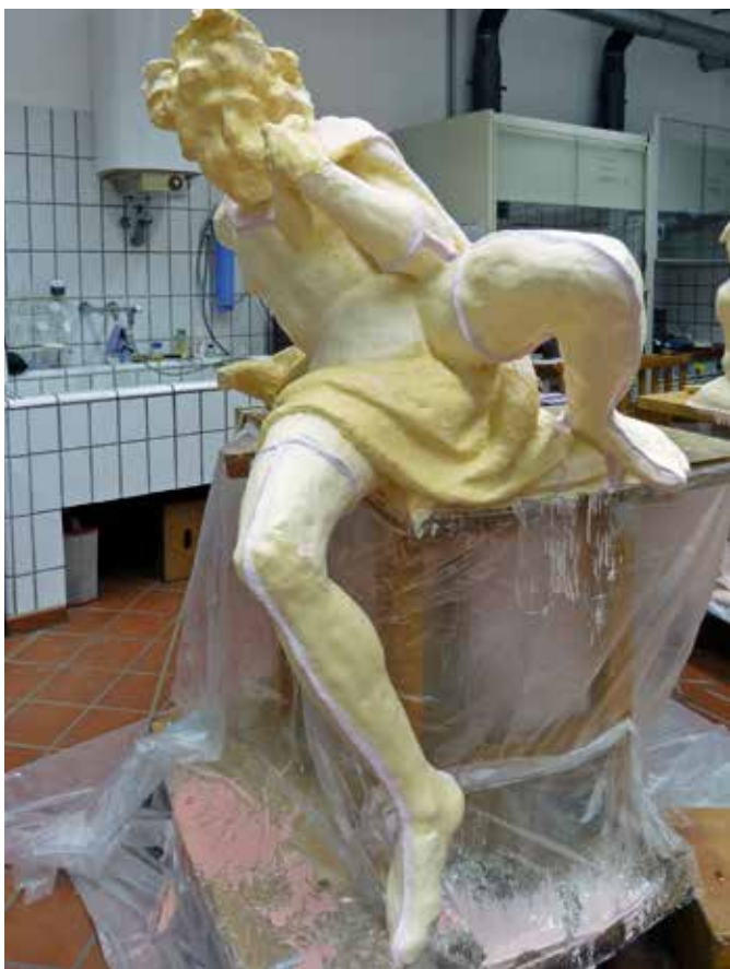
Silikon wird in mehreren Schichten aufgebaut bis eine ausreichende Stabilität erreicht ist, dann werden die Teilungsnähte zur Abnahme der Formeinzelteile festgelegt und mit Silikon markiert
