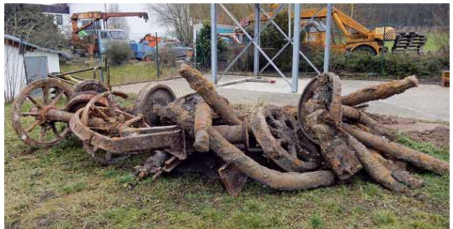
Durch die Gemeinde sichergestellte Zugteile mit zum Teil massiver, explosionsbedingter Verformung (Foto: ArchDienst GmbH & Co. KG, Matthias Tschuch)
