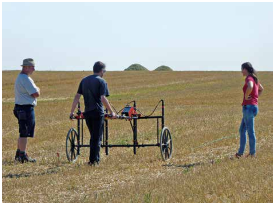
Möckenlohe, Gde. Adelschlag, Lkr. Eichstätt. Geophysikalisches Messgerät (Magnetometer) im Feldeinsatz (Foto: BLfD, Jörg W. E. Fassbinder)
